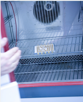
Zyklischer Temperaturstress, z.B. für große Leiterplatten
